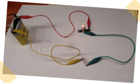
Bild 5: Einfacher Stromkreis
