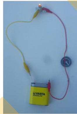
Bild 6b: Stromkreis geschlossen – Kompassnadel wird abgelenkt
