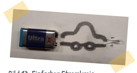
Bild 17: Einfacher Stromkreis mit Graphit
