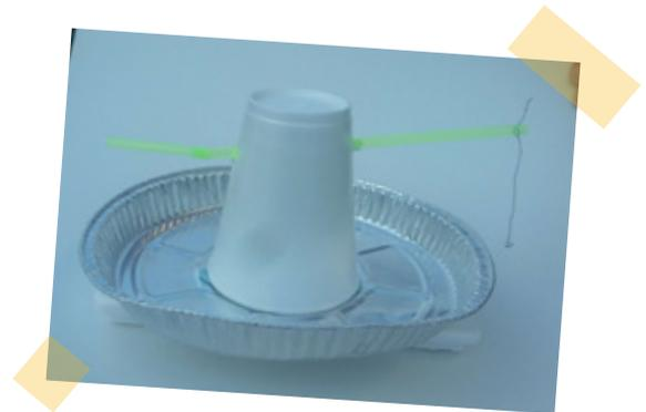
Bild 3: Einfaches Elektroskop
